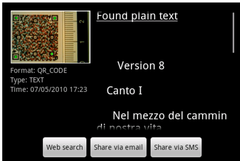
Figura 5.5: Screen relativo alla lettura di un simbolo di versione 8L a 4 colori su htc magic. Si noti come la dimensione sia inferiore al pollice quadrato.
