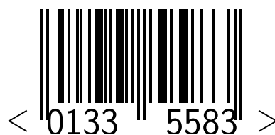
Figura 1.1: Un esempio di Codice a Barre Ean-8.
