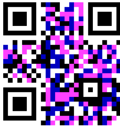
Figura 5.1: Esempio di codice di tipo 2H che utilizza uno schema a 4 colori (2 bits/modulo) per la rappresentazione ottica dei dati.
