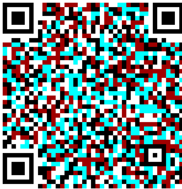
Figura 5.2: Esempio di codice di tipo 6H a 4 colori (2 bits/modulo).
