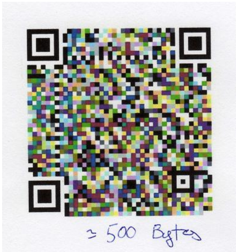
Figura 5.6: Screen relativo alla scansione di un simbolo a 16 colori in ambiente desktop, ottenuta tramite scanner Epson Dx6000, che è stata decodificata con successo.
